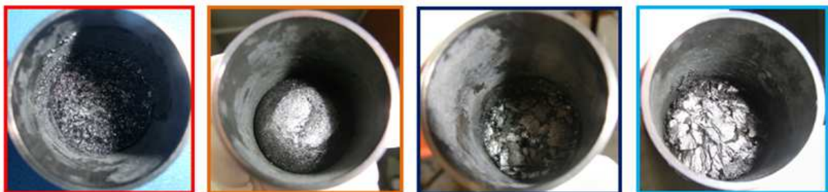
Figure 13 : Photographies des résidus obtenus après la mesure de la force pour les échantillons préparés au rhéomètre (rouge : PU, orange : PU 30%APP, bleu foncé : PU 29%APP 1% nano MgO et bleu clair : PU 28%APP 2% nano MgO)
