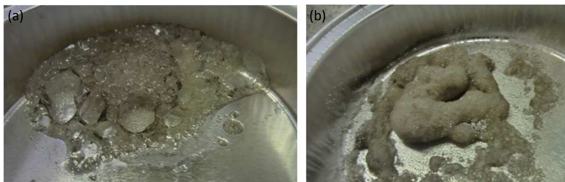
Figure 11 : Photographies des résidus obtenus après traitement thermique à 10°C/min jusqu'à 400°C (APP seul (a) et de 28%APP 2% nano MgO (b))
