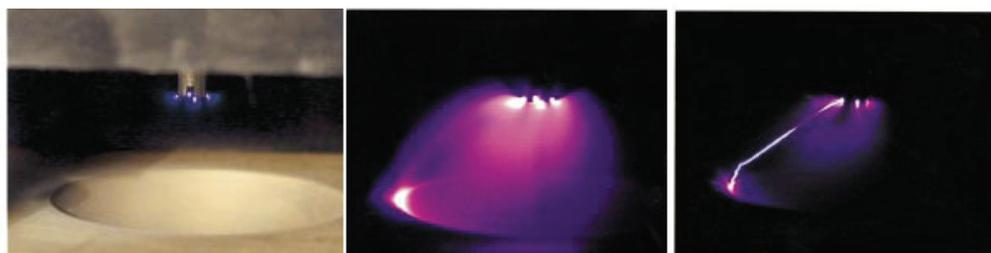
**Figure I-2: Régimes différents dans la décharge couronne négative : a) Couronne, b) Luminescence, c) Etincelle <sup>[10]</sup>**
