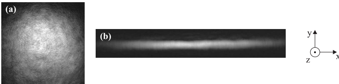
FIGURE 1.19: Sections transverses du faisceau de pompe en rétro-action optique sous le seuil : (a) à la sortie du laser en configuration 2D, mode TEM_{00} , (b) après la lunette astronomique, faisceau profilé en configuration 1D.
