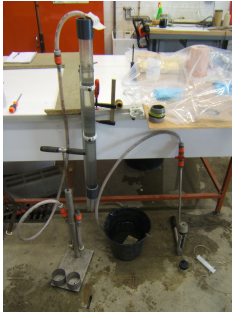
FIGURE 2.4.1: Sous échantillonnage des carottes en tranche de 2cm
