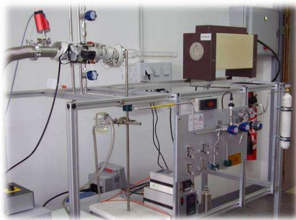
Figure 3.28: Banc d'échange isotopique mis en place à l'UCCS.
