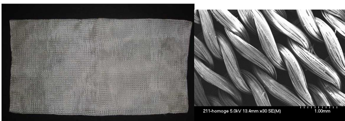
Figure 26 : Tricot de PLLA et grossissement (x 30) d'une maille par MEB
