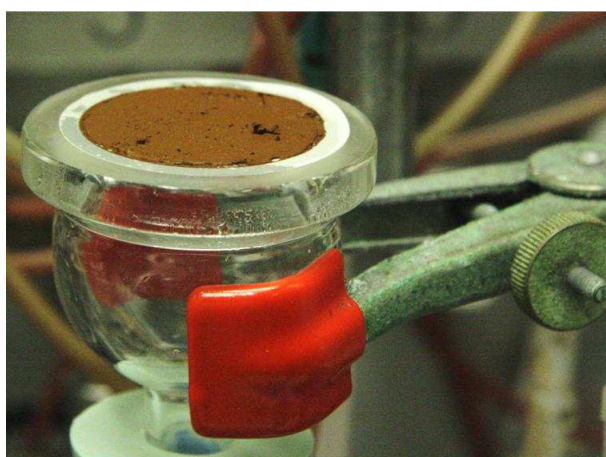
Figure 65 : Photo du précipité d'uranium obtenu par bullage d'argon humide en milieu \text{LiCl-CaCl}_2 (30-70% mol ) fondu.
