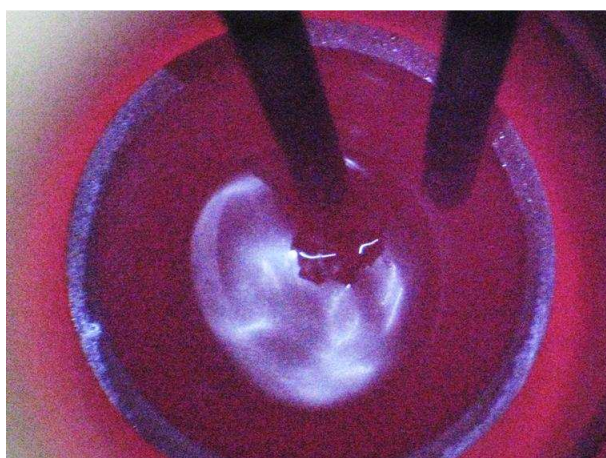
Figure 58 : Bullage de l'argon humide dans le sel fondu.
