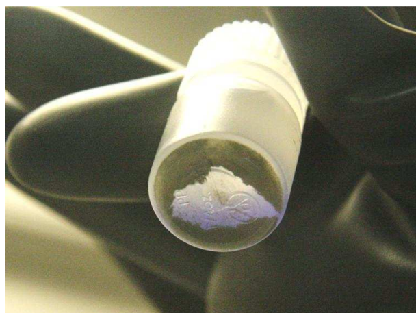
Figure 87 : Introduction du précipité de plutonium dans \text{HCl} 1M avec dissolution sélective de \text{PuOCl} .
