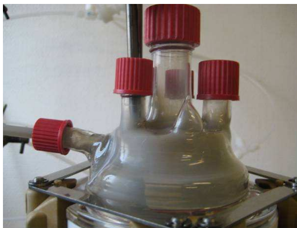
Figure 64 : Dépôt présent sur les parois froides du réacteur au cours de la précipitation de l'uranium (III) par l'argon humide.
