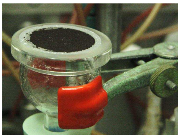
Figure 66 : Photo du précipité d'uranium obtenu par bullage d'argon humide pollué à l'oxygène en milieu \text{LiCl-CaCl}_2 (30-70% mol ) fondu.
