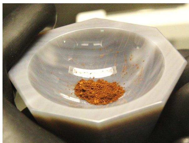
Figure 59 : Précipité d'uranium après dissolution du bloc de sel, filtration et séchage.
