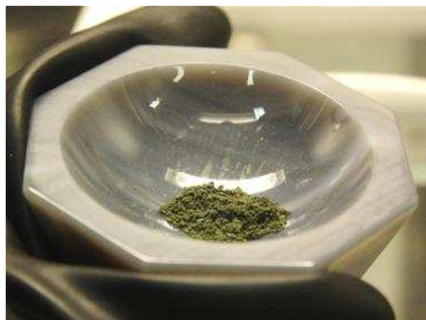
Figure 85 : Précipité de plutonium, après dissolution du sel, filtration et séchage.
