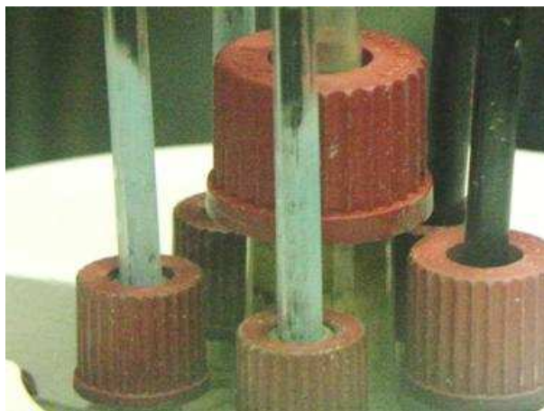
Figure 92 : Dépôt bleu de condensat de \text{PuCl}_3 , sur les parties du tube initialement présent à l'intérieur du réacteur, causé par la volatilisation d'une partie du plutonium au cours de la carbochloration.
