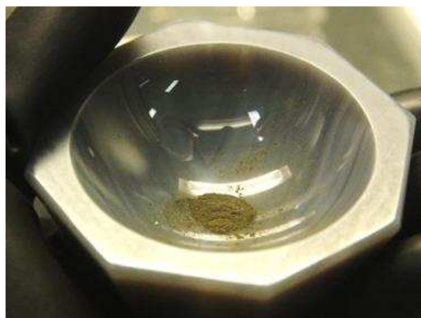
Figure 88 : Poudre de \text{PuO}_2 à l'issue du lavage d'une partie du précipité de plutonium à l'acide 1M.
