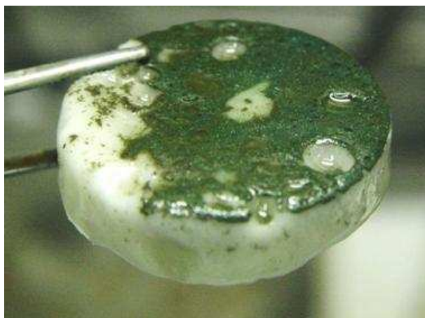
Figure 84 : Bloc de sel à l'issue de la précipitation du Pu(III) et retour à température ambiante, en cours de dissolution dans l'eau.
