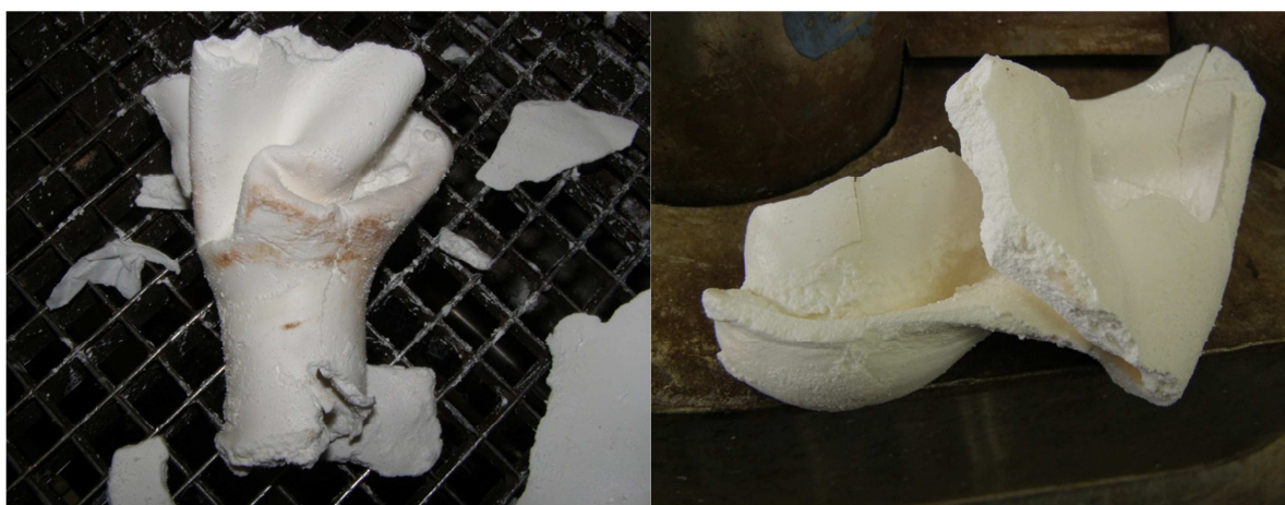
Figure III-18 : Prise en masse partielle du polymère dans le réacteur pilote lors de la polymérisation en présence de kickers.
