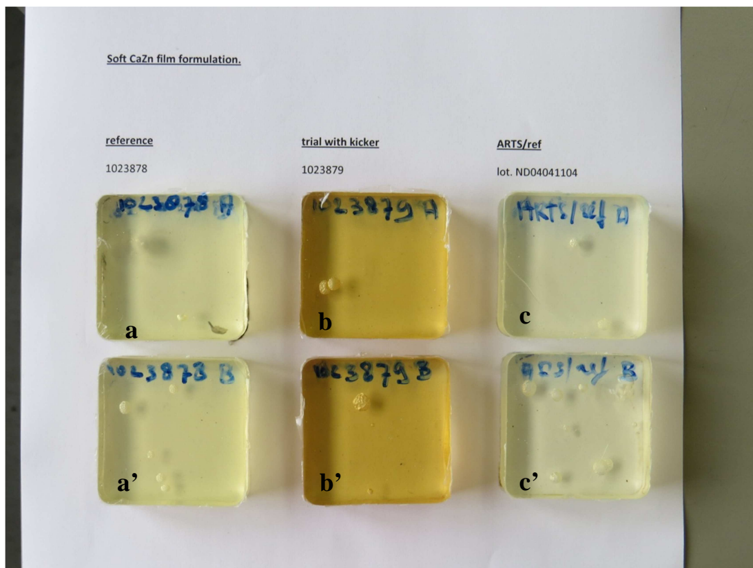
Figure IV-9 : Test de stabilité thermique en présence ou en absence de kicker avec différents tensioactifs.
