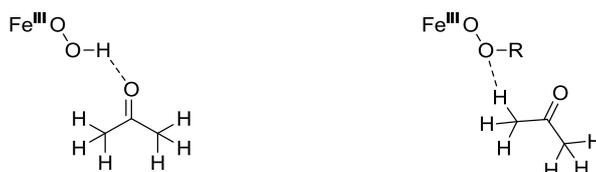
**Figure 16** : Formation hypothétique de liaisons hydrogènes entre l'intermédiaire  $LFe^{III}-OOH$  et le solvant stabilisant alors l'hydroperoxo-ferrique.<sup>73</sup>
