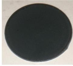
**Figure IV-7 :** Photographie représentant un film sulfuré sur substrat de verre
