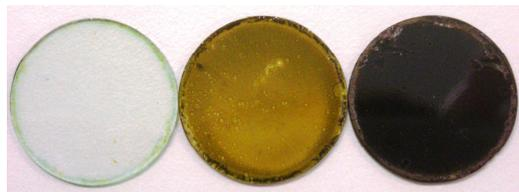
**Figure III-7** : Films contenant 3 couches de sol de Cu-In à base de DEA, et ayant subi des traitements thermiques sur plaques chauffantes (de gauche à droite) à 150°C, 200°C, et 250°C
