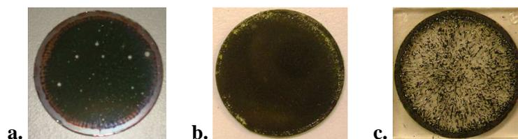
**Figure III-9 :** Défauts observés sur les films : **a.** cratères, **b.** fissuration des bords, **c.** délamination
