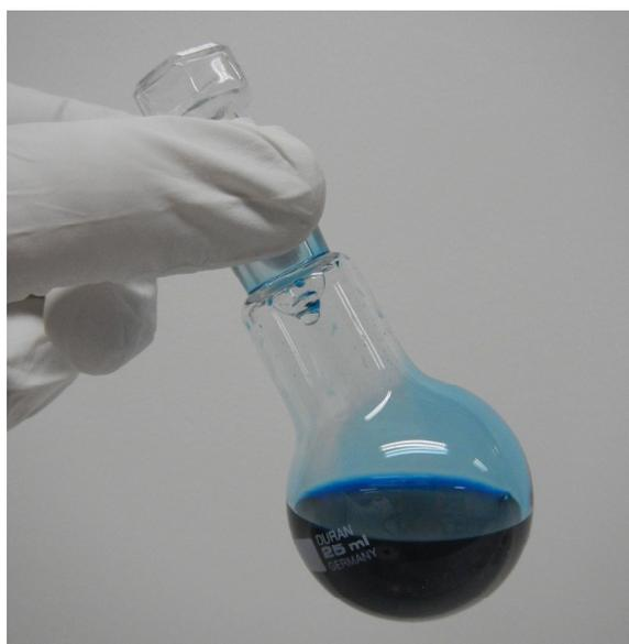
**Figure 1** : Ballon monocol contenant un sol de Cu-In synthétisé à partir de DEA
