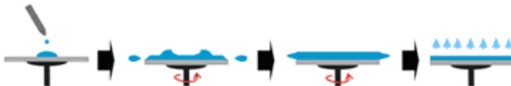
Figure I-26 : Illustration du dépôt par "spin-coating"
