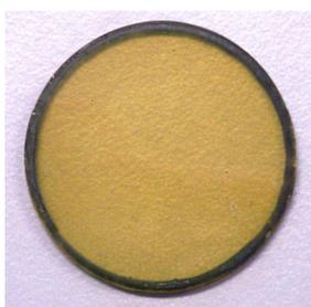
**Figure III-11** : Photographie d'un film constitué d'un dépôt optimisé de sol de Cu-In à base de DEA
