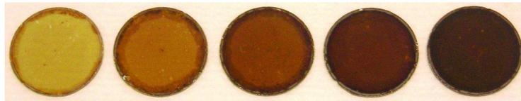
**Figure III-18** : Films d'oxydes de Cu-In composés (de gauche à droite) de 1 à 5 dépôts
