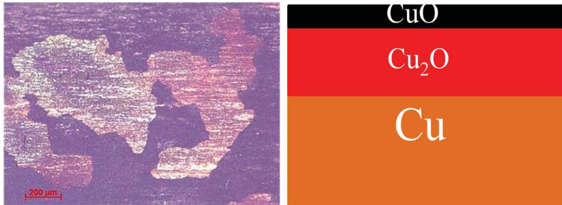
Figure IV.25: les couches d'oxyde qui se forme sur la surface des éprouvettes lors des essais à haute température.
