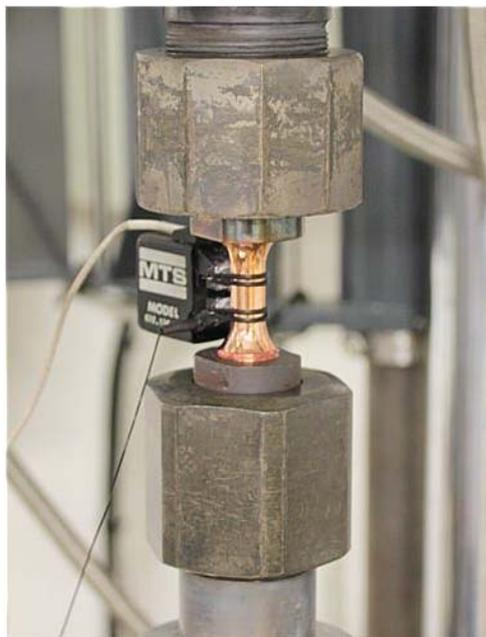
Figure II.3: Extensomètre collé directement sur l'éprouvette.
