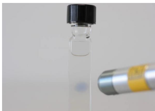
Figure 1-3 : Coloration instantanée d'une solution d'HABIs ( pseudogem-bisDPI[2.2]PC ) [151] dans le benzène sous irradiation continue à 365 nm
