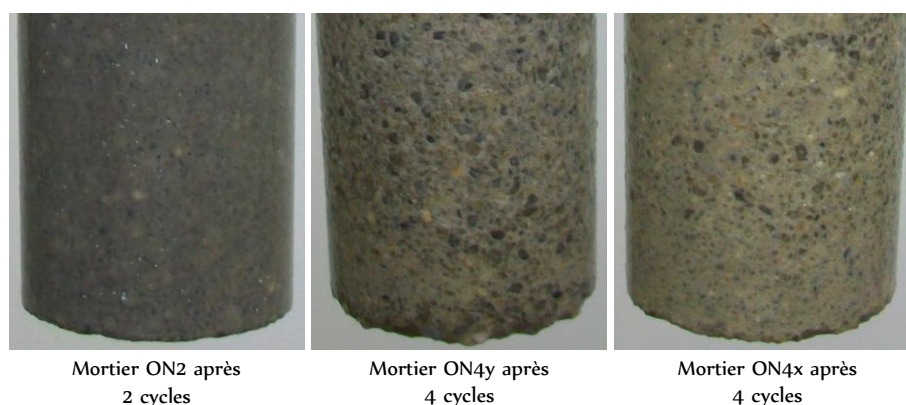
Figure 125 : Mortier OPC après 2 cycles et 4 cycles de biodétérioration par H. neapolitanus .
