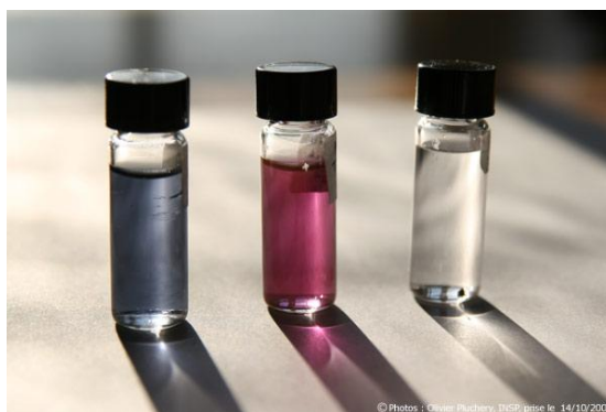
Figure 19 - En fonction de la forme des nanoparticules, la solution apparaît avec diverses colorations. De gauche à droite, nanobatonnets d'or de 14 nm de diamètre et 25 nm de long, nanoparticules d'or sphériques de 15 nm de diamètre, flacon d'eau contenant des particules à base d'or de grande taille (1mm) [GdR Or-nano].
