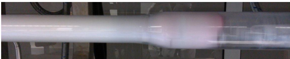
Figure 123 – Photographie du poreux de la préforme imprégnée par la solution Sol-Au après une passe de préchauffe à 1200 °C.
