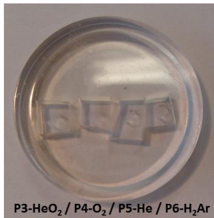
Figure 99 – Cœur des quatre préformes fabriquées, de gauche à droite, sous atmosphère semi-oxydante, oxydante, neutre et réductrice.
