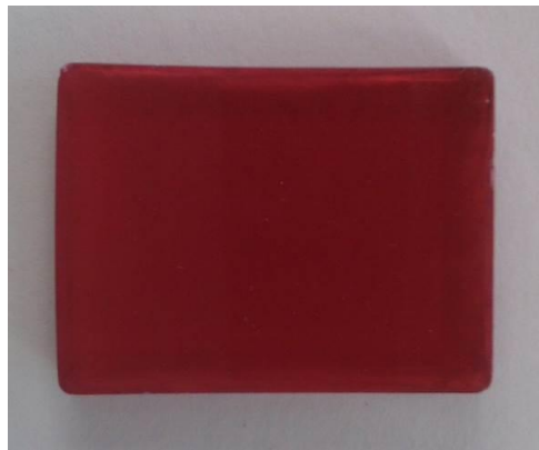
Figure 132 – Photographie d'une plaque de silice Sol-Gel dopée par des nanoparticules d'or avec la technique de Sol-dopage par la solution Sol-ZrAu. Echantillon poli au \frac{1}{4} de \mu\text{m} . Dimension de l'échantillon: l = 23 mm, L = 16 mm, e= 1,6 mm.
