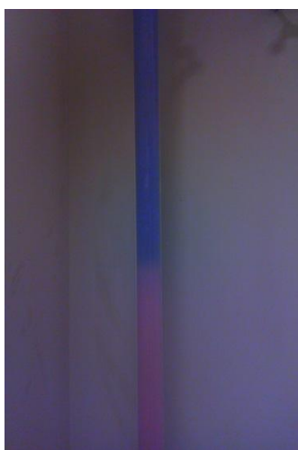
Figure 124 – Aspect de la préforme optique après 3 imprégnations par la solution Sol-Au et 3 traitements thermiques à 250 °C. La zone correspondant au début du dépôt est la partie haute de la photographie.
