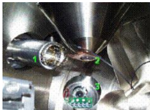
Figure 117 : Intérieur de la chambre d'un MEB Philips XL30 équipé d'un détecteur d'électrons secondaires (1), d'un détecteur d'électrons rétrodiffusés (2) et d'une sonde EDXS (3).
