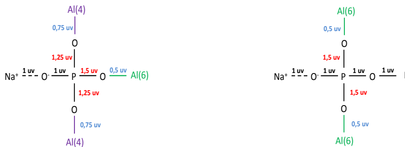
a) Répartition Na, Al dans un groupement isolé b) Répartition Na, Al dans un groupement terminal
