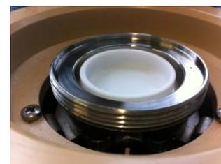
Figure 190: Cellule en téflon utilisée dans le PetroOxy.
