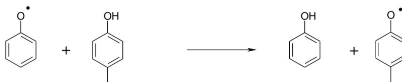
**Figure 18:** Réaction considérée pour le calcul des BDE selon une méthode isodesmique.
