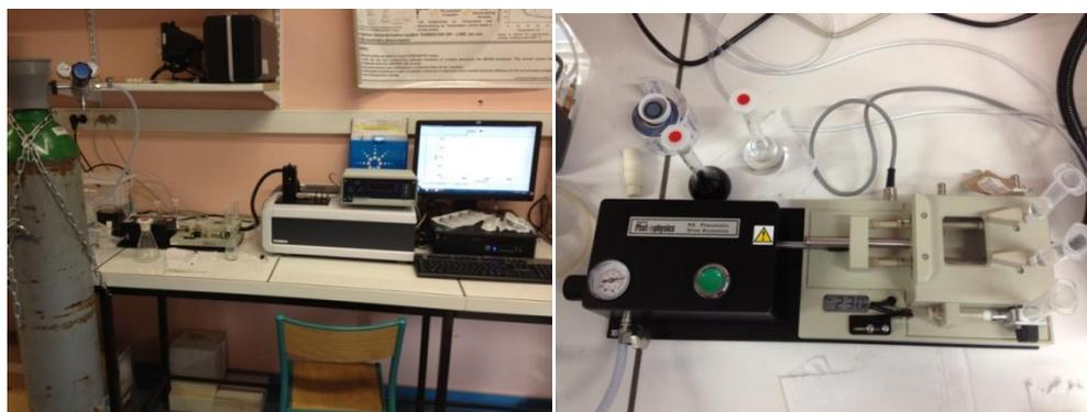
Figure 216: Photographies du spectromètre UV-Visible Cary 60 et du système stopped-flow.
