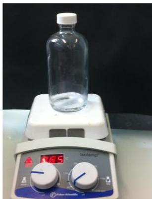
*Figure 217: Oxydation de 5 mL du décanal 2M à 80 °C en présence de 0,04 mM d' $\alpha$ -tocophérol et/ou 0,04 mM de BHT dans une bouteille de 125 mL saturée en oxygène.*
