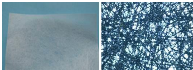
Figure 5: Photo du PET non-tissé et observation par microscope optique (x5)
