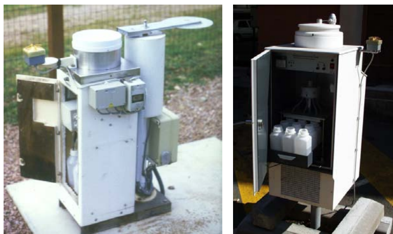
Figure 2-2 : Observatoire MERA : les collecteurs de retombées humides Précis Mécanique®/Icare® (gauche) et Eigenbrodt® NSA 181/KHS (droite)
