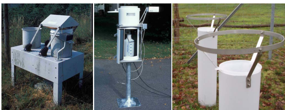
Figure 2-4 : Observatoire CATAENAT : les collecteurs de retombées humides Andersen® APS (gauche) et Eigenbrodt® UNS 130/S (milieu) et les collecteurs de retombées totales par jauge d'Owen (droite)
