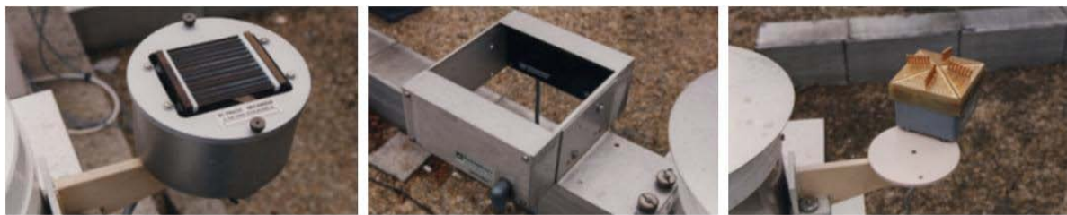
Figure 2-5 : Détecteurs de précipitations : de gauche à droite le modèle Précis Mécanique ® , et les modèles Eigenbrodt ® IRSS88, et RS85
