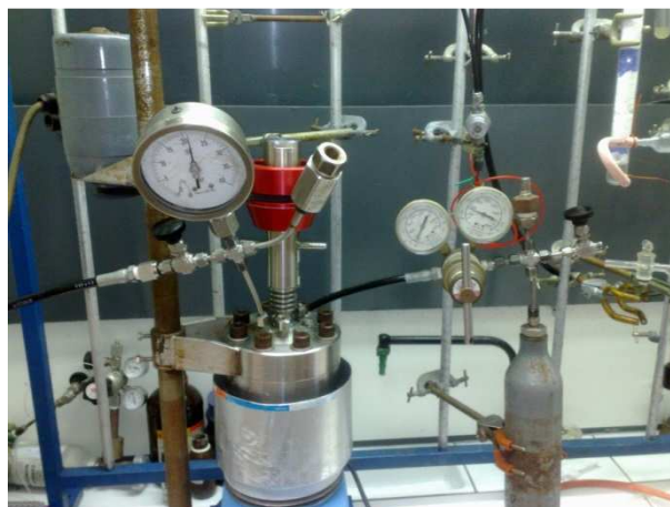
Figure 60. Photographie montrant le réacteur de 400 ml (avec son ballast) utilisé pour les premiers sur plus grandes quantités
