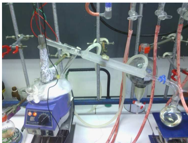
Figure 72. Montage de distillation permettant la purification des diesters d'isosorbide C7.
