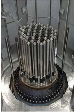
Figure I-6 : le couvercle du réacteur avec les grappes de contrôle [7]
