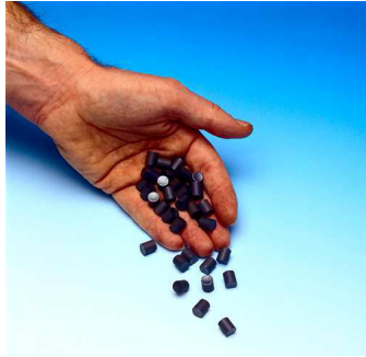
Figure I-4 : Pastilles de combustible [5]
