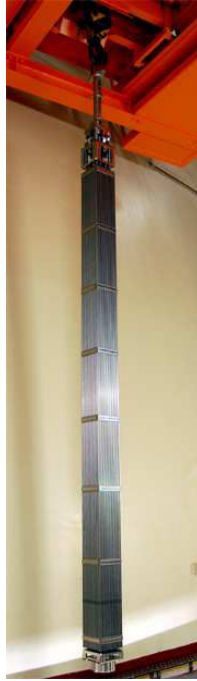
Figure I-5 : Assemblage de combustibles [6]
