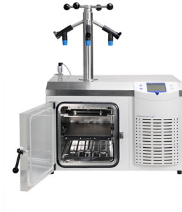
FIGURE 1.4 – Lyophilisateur Martin-Christ type Epsilon 2-4D installé dans l'équipe INSERM U1008 à l'Université de Lille 2
