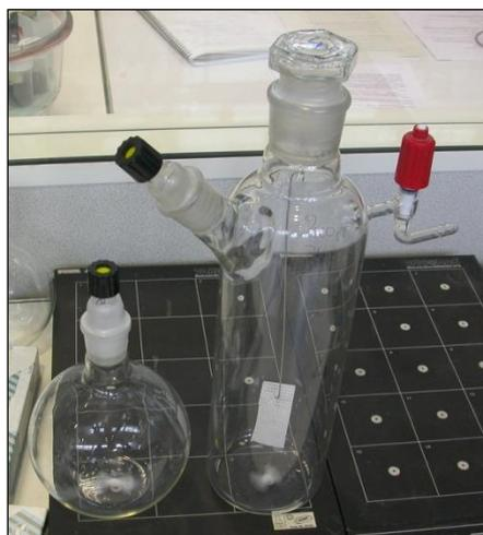
Figure 23 : Ballon de préparation (à gauche) et réacteur d'adsorption (à droite) utilisés pour l'étude de l'adsorption des COV sur le média photocatalytique Ahlstrom
