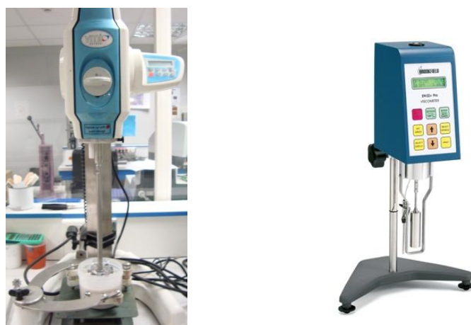
Figure 93. Disperseur (gauche) et viscosimètre (droite) utilisés pour la préparation et le contrôle des formulations.
