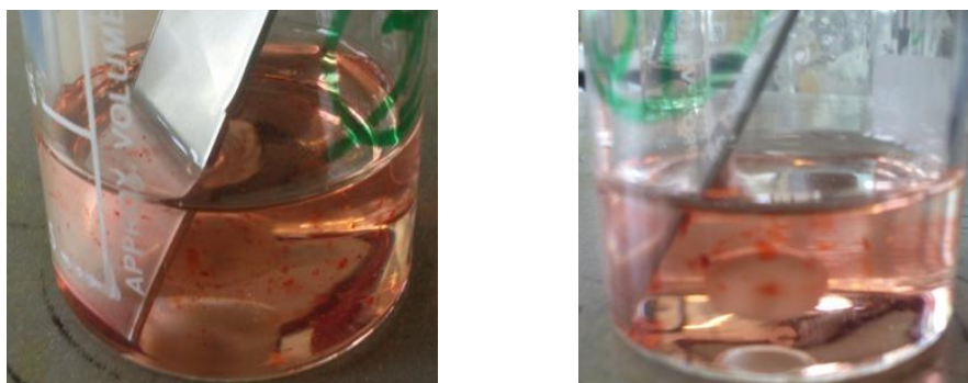
Figure 160. Observation en cours d'expérience des mécanismes combinés de rolling-up et de solubilisation dans le bain de dégraissage réalisé à l'aide d'une microémulsion à base d'oléate de méthyle (gauche, n°33) et d' \alpha -pinène (droite, n°35).
