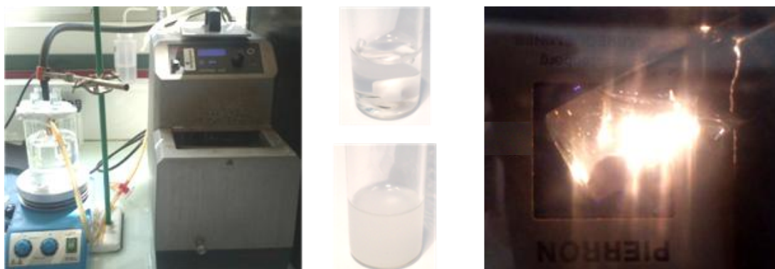
Figure 181. Montage utilisé pour la construction des diagrammes de phase (gauche) et comportements observés : microémulsions (milieu, haut) ou mélanges polyphasiques (milieu, bas). Les cristaux liquides sont identifiés par biréfringence en lumière polarisée (droite).
