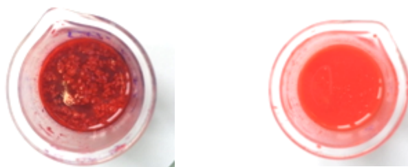
Figure 177. Aspect du bain (vue de dessus) après l'opération de dégraissage. La microémulsion n°65 (gauche) met principalement la graisse en suspension alors que la microémulsion n°66 (droite) la solubilise.
