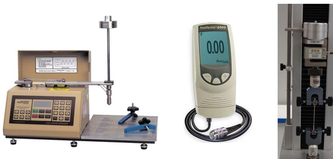
Figure 94. Abrasimètre (gauche), appareil de mesure de l'épaisseur (milieu) et banc de traction (droite) utilisés pour caractériser les revêtements.
