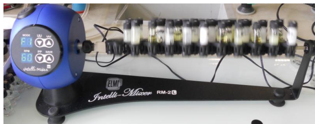
Figure 91. Système d'agitation des piluliers utilisé dans le cadre du protocole de Hansen.
