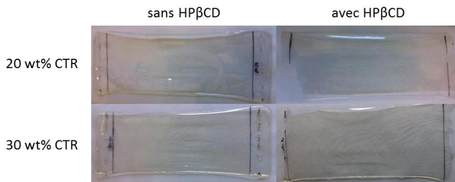
Figure VII.III. 1. Photographies des films de compositions intermédiaires (20 wt% et 30 wt% de CTR) avec 30 wt% ou sans HP $\beta$ CD réticulés 120 min
