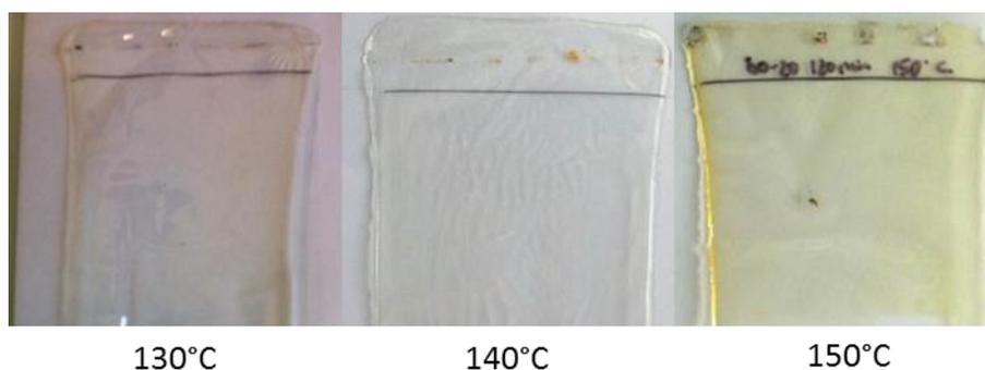
Figure VII.III. 7. Photographie des films de PVOH/CTR-80/20-120min réticulés à températures croissantes
