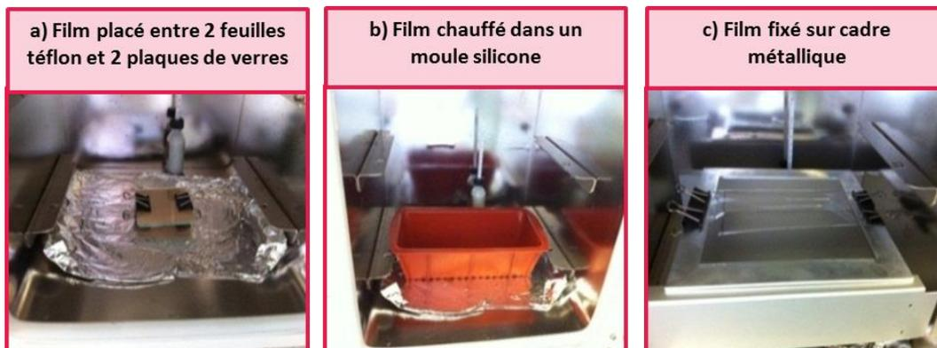
Figure VII.II. 21. Photographies des procédés utilisés pour la réticulation des films
