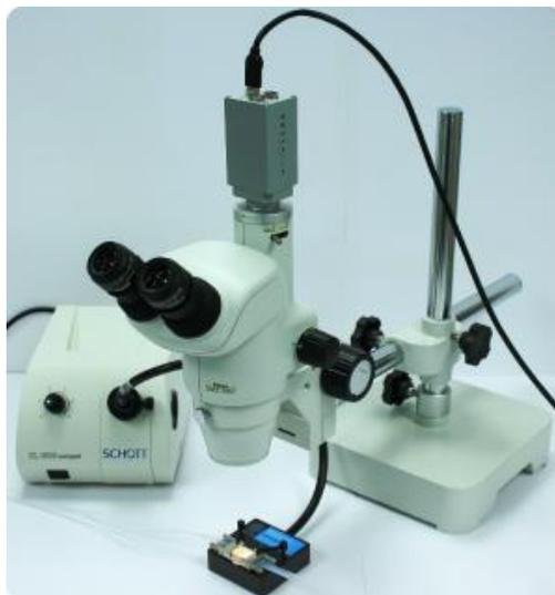
Figure 2.12 Microscope d'haute définition fourni par Dolomite pour l'analyse de la formation des gouttes (Dolomite, 2011).
