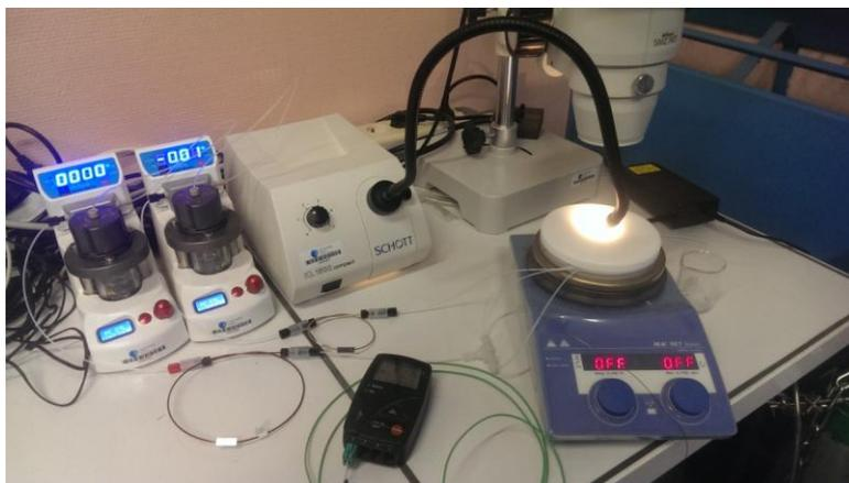
**Figure 2.43** Montage pour le contrôle de la température de la puce.
