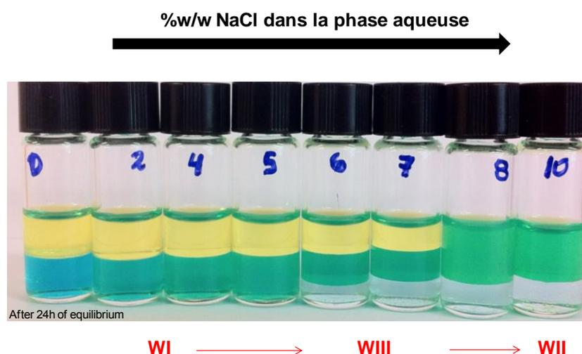
**Figure 2.14** Balayage de formulation du système SDS butanol/Toluène/Eau pour des concentrations en NaCl variant de 0 à 10%. 2% SDS,  $f_w = 0,5$  et 4 % de butanol.
