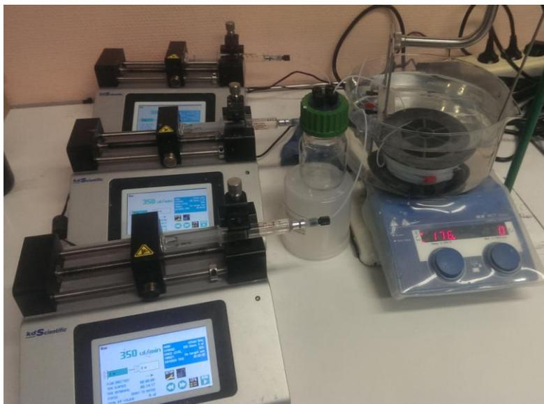
**Figure 3.30** Système en continu mis en place pour l'oxydation d'alcènes dans un microréacteur.
