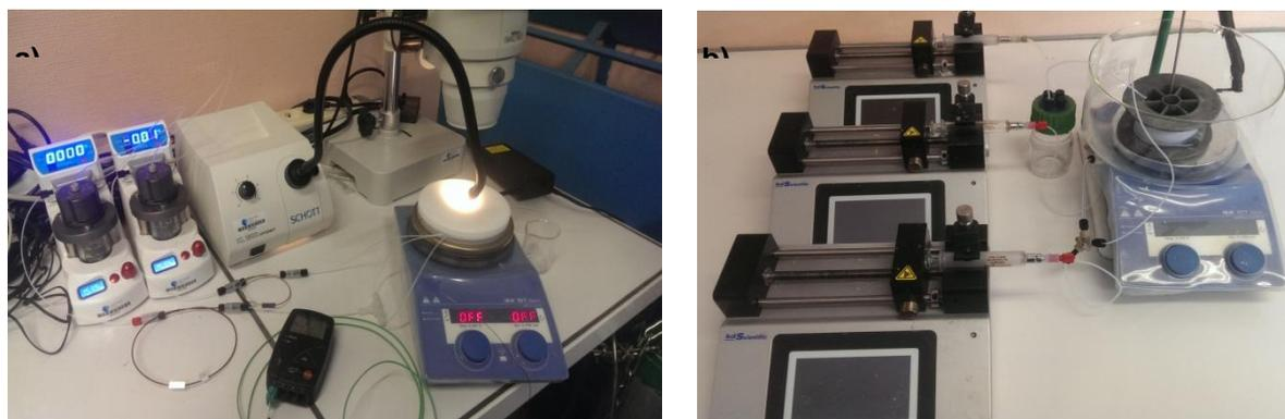
**Figure 2** Appareils mis en place pour les études a) des systèmes SHE dans des microcanaux et b) pour l'oxydation catalytique dans des émulsions de Pickering.
