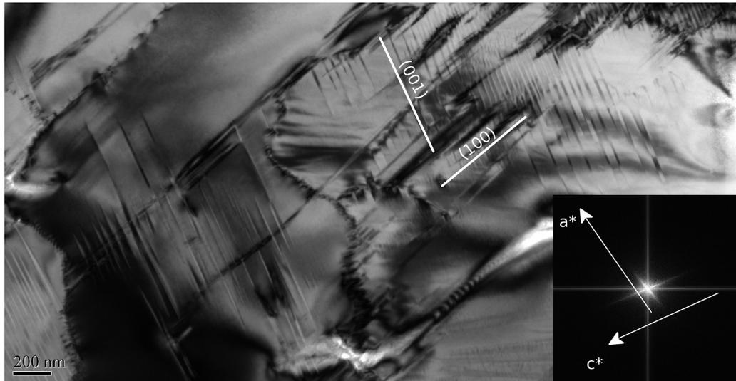
FIGURE 4.10 – Lamelles d'exsolution orientées dans le plan (001) principalement. On observe une seconde orientation d'exsolutions dans le plan (100). En bas à droite de l'image, l'insert montre la transformée de Fourier de la zone au-dessus où l'on observe les deux directions d'exsolution. On voit apparaître les directions  $a^*$  et  $c^*$  perpendiculaires aux plans d'exsolution.
