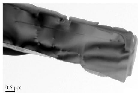
FIGURE 5.8 – Exemple d'une lame FIB pour les analyses par microscopie électronique en transmission.
