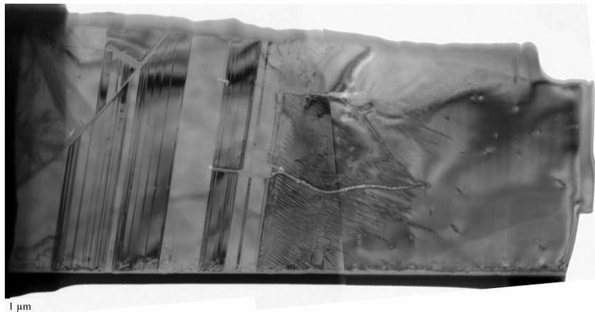
FIGURE 4.5 – Exemple d’une lame FIB prélevée dans un pyroxène. La partie gauche du grain est constituée de clinoenstatites contenant des défauts plans selon (100). La partie droite est un pyroxène calcique présentant des microstructures d’exsolutions.
