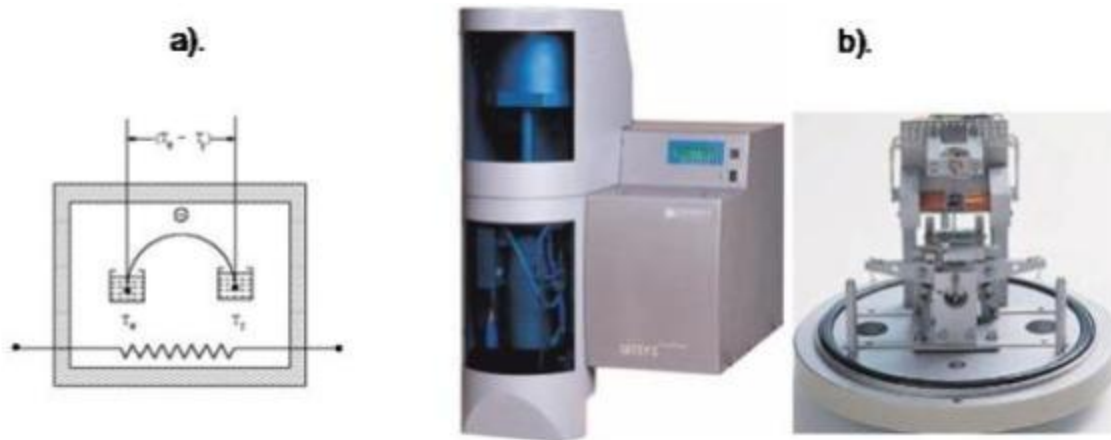
Figure I.9 – a. Enceinte de l'ATD-ATG contenant l'échantillon et le témoin ( \alpha\text{-Al}_2\text{O}_3 ) et b. Deux thermo balances couplées (ATG-ATD/DSC).
