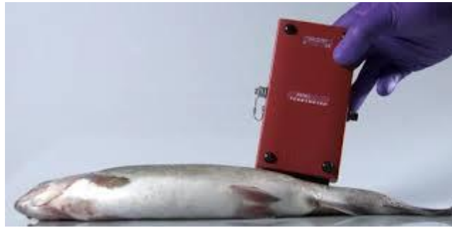
Figure 2-17 : Illustration de l'utilisation d'un Torry meter pour mesurer l'état d'altération d'un poisson entier.
