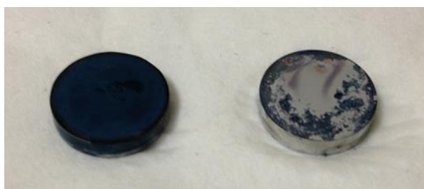
Figure V.124 : Photographies des pastilles fonctionnalisées avec la PDA et le polyCD après 6 jours dans le PBS : (gauche) le film PDA a été recuit à 150°C pendant 1h et (droite) le film PDA n'a subi aucun traitement thermique
