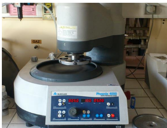
Figure PE.155 : Polisseuse automatique utilisée pour la préparation des échantillons de titane
