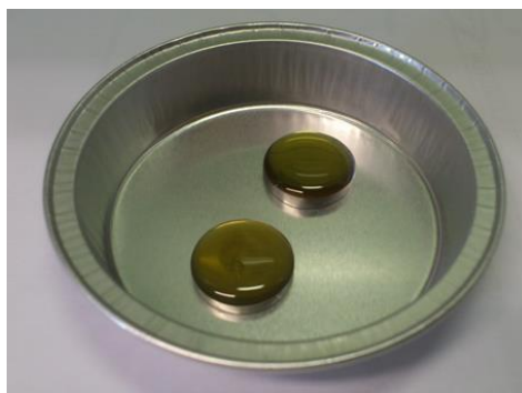
Figure PE.156 : Illustration de la réalisation du dépôt des solutions concentrées sur les surfaces de titane permettant d'engendrer les réactions de Diels-Alder et de thiol-ène
