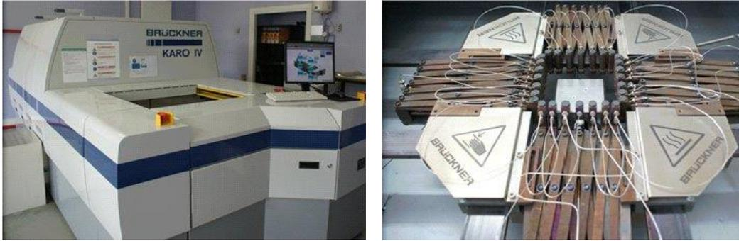
Figure 2.10 : Photographies de la machine de biétirage et du système de prise en pince de l'échantillon
