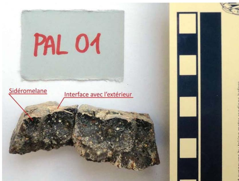
Figure 104 – Croûte vitreuse du coussin de lave de l'échantillon PAL 01.
