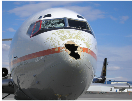
FIGURE 2.2 – Avion après un bombardement de grêle, à l’aéroport de Calgary (Canada). Photo AFP franceinfo.fr.
