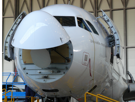
FIGURE 2.3 – Antenne radar située à l'intérieur du nez d'un Airbus A320. « Airbus A320-214 Vueling Airlines EC-HTD » par curimedia – Flickr.
