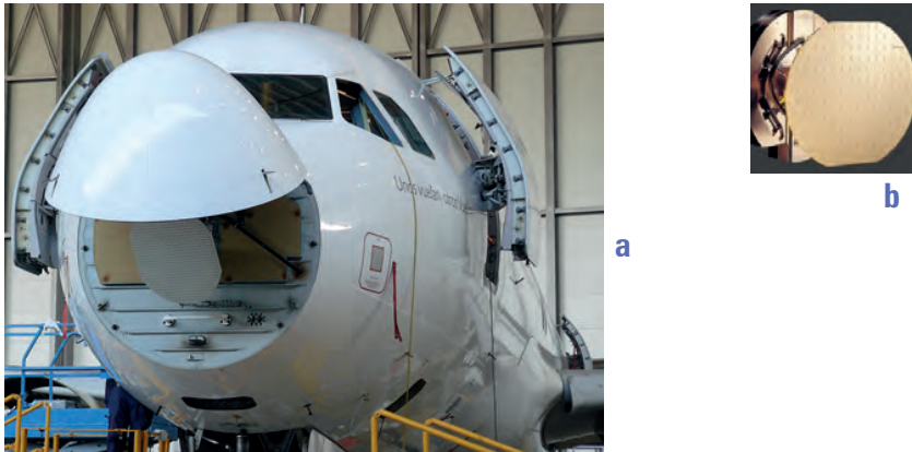
Figure 2. a. Photographie ( http://commons.wikimedia.org/wiki/File:Airbus_A320-214_Vueling_Airlines_EC-HTD.jpg ) d'une antenne radar dans le nez d'un avion commercial. La partie levée est appelée le radôme. b. Photographie ( http://www.radartutorial.eu/15.weather/wx15.fr.html ) d'une antenne à réseau de phase.
