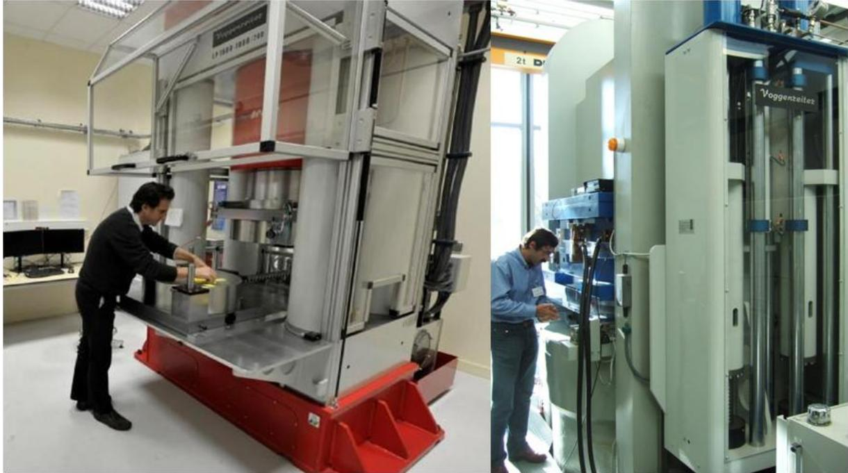
**Figure 3.1** : Photographies des presses multi-enclumes de Clermont-Ferrand à gauche et de Bayreuth à droite.
