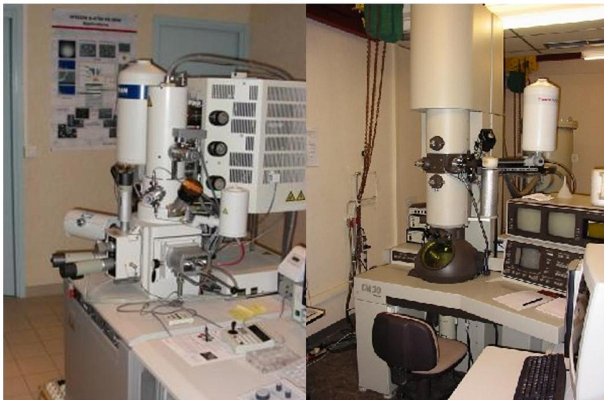
**Figure 3.14 :** Photographie du MEB Hitachi S4700 à gauche et du MET Philips CM30 du Centre Commun de Microscopie de Lille 1 à droite.
