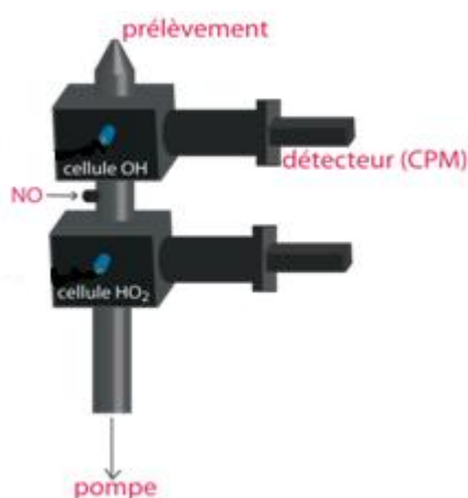
Figure 8 : Schéma représentatif des cellules de mesure du dispositif UL-FAGE
