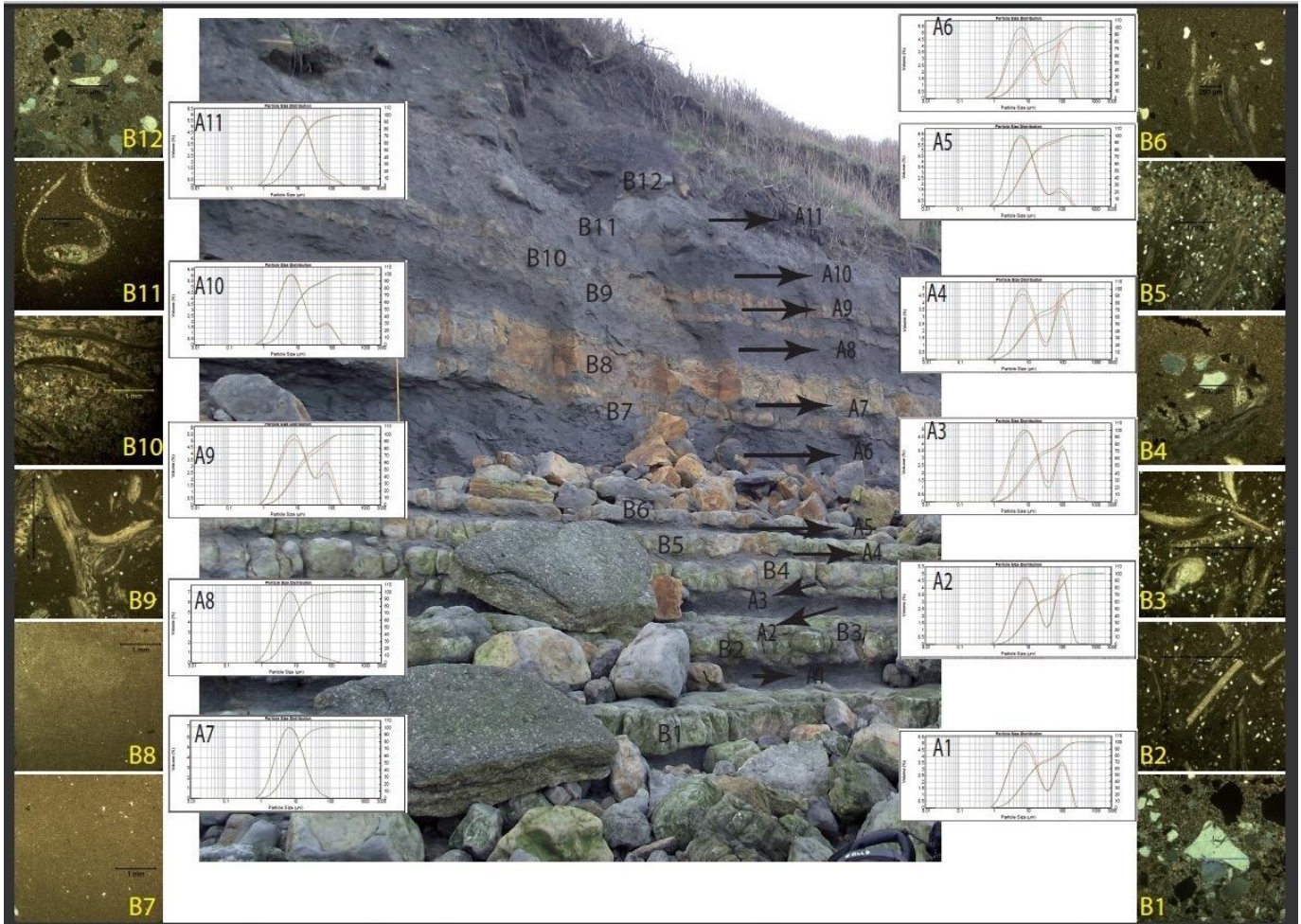
Figure 3. La graduation granulométrique des bancs (B1-B12) et des inter-bancs (A1-A11) du CMW au Gris-Nez.
