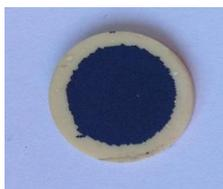
Figure V-8. Pastille de CGO avec dépôt d'électrode composite à base de  $Ba_2Co_9O_{14}$
