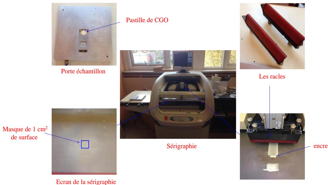
Figure II-8. Photo de l'appareil de sérigraphie utilisé pour cette étude
