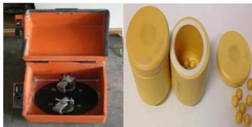
Figure III-6. Broyeur planétaire et bols en zircone utilisés pour le broyage
