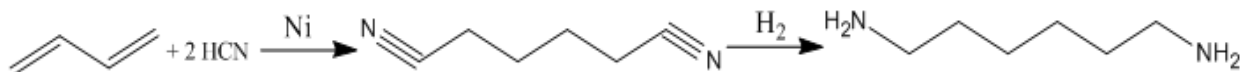
Figure 2 : exemple de procédé de synthèse d'amine par addition électrophile (synthèse de l'HMD - 1,6-hexanediamine).
