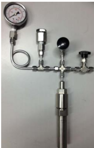
Figure 17 : Autoclave utilisé pour les réactions en milieu fermé avec l'ammoniac.
