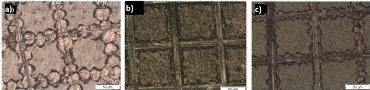
Figure 4.24 : Images en microscopie optique après le test d'adhérence par cross-cut pour a) revêtement sol-gel hybride non-chargé et b) revêtement contenant 1% de  $Fe_3O_4$  et c) revêtement contenant 0,58% de  $Ce(NO_3)_3$  + 1% de  $Fe_3O_4$
