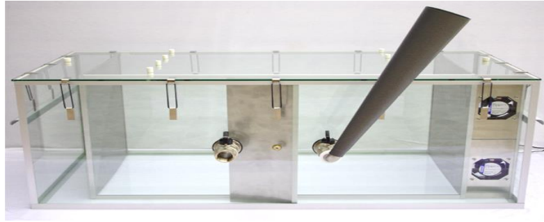
Figure I - 5 : Photos d'une chambre d'essai d'émission de forme rectangulaire (CLIMPAQ de 50 litres).
