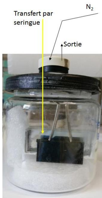
**Photographie V.30.** Fiole scellée par un septum, utilisée en tant qu'enceinte pour garder le moule sous  $N_2$  pendant la polymérisation.
