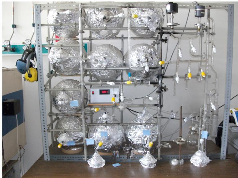
Figure III.8: Photo du bâti de dilution utilisé pour la préparation des mélanges étudiés.
