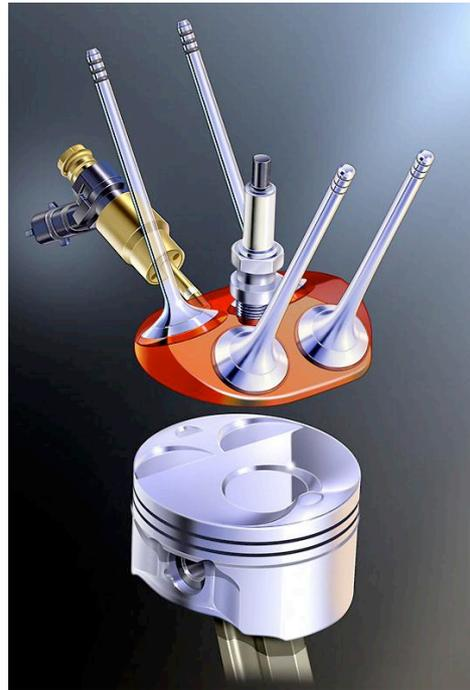
Figure I.9 : Schéma d'un moteur à allumage commandé [9].
