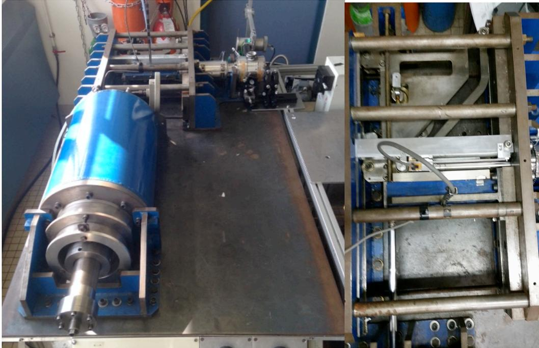
Figure III.3: a) Photo d'ensemble de la MCR de Lille. b) Vue de haut du couplage mécanique des deux pistons.
