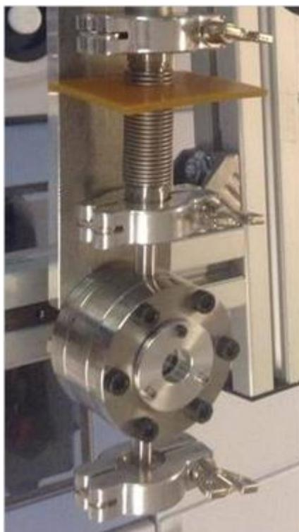
**Figure 2.3 :** Cellule optique pour la caractérisation *in situ* de l'adsorption dans les films zéolithiques par spectroscopie IRTF.
