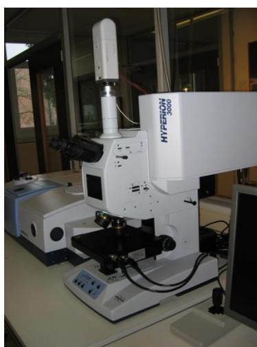
**Figure 2.2 :** *Microscope infrarouge HYPERION 3000 couplé à un spectromètre Vertex 70 (Société Bruker).*
