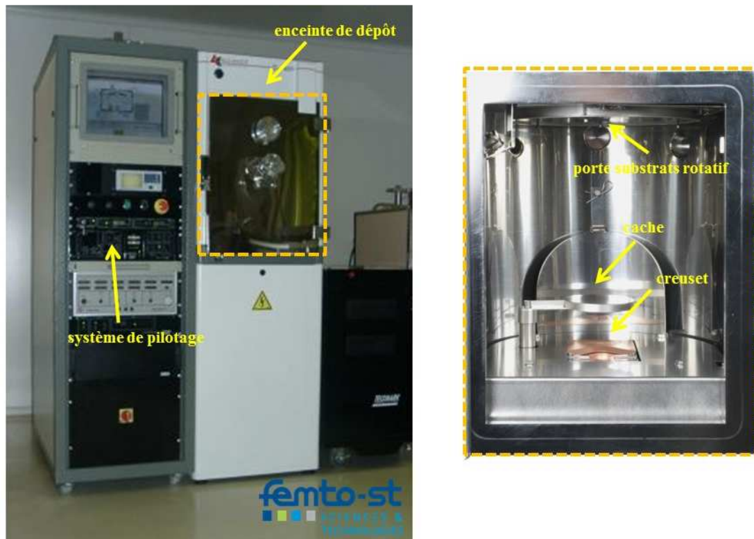
Figure II-3 : Photographie du dispositif d'évaporation disponible au laboratoire FEMTO-ST
