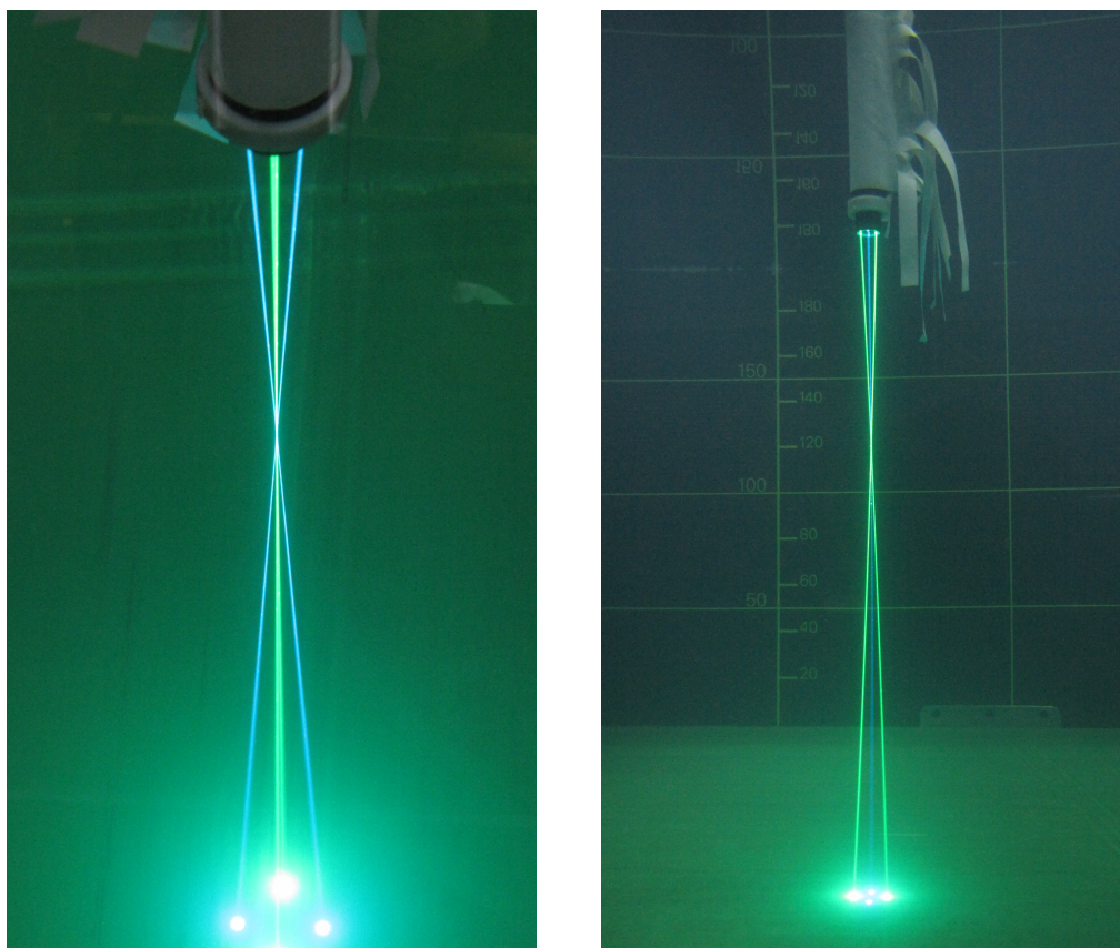
FIGURE 60 – Photos du capteur optique LDV. Le volume de contrôle correspond à l'intersection des deux faisceaux lumineux rouge et bleu.
