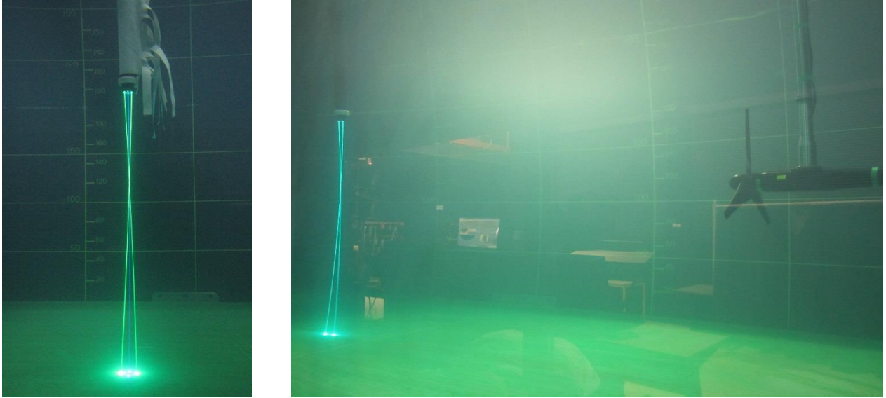
Figure 1: Montage du dispositif expérimental, les mesures de courant réalisées par le système LDV sont effectuées en amont d'une maquette d'hydrolienne située à une distance de 4 fois son diamètre D.
