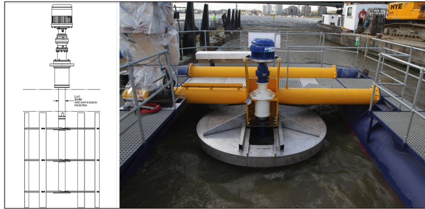
FIGURE 48 – A gauche : schéma du prototype d'hydrolienne de type Darrieus. A droite : l'hydrolienne à axe verticale installé sur le ponton. Crédits photo : PROTIDE.
