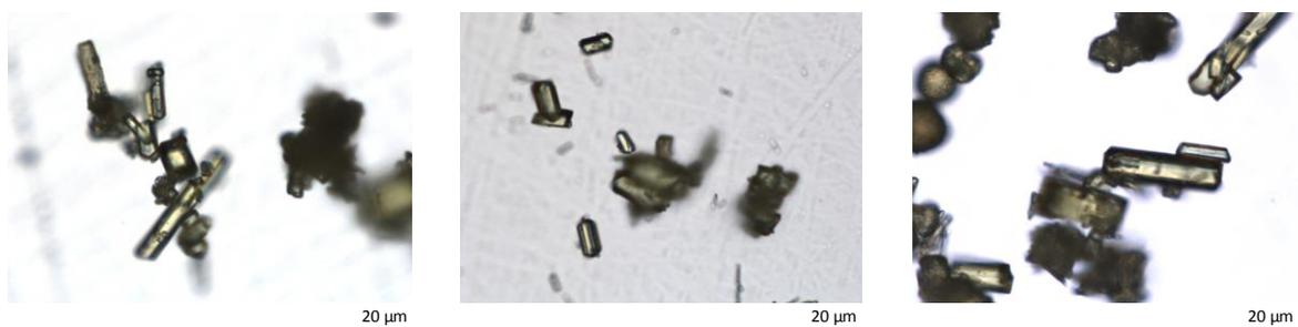
Figure 89 : Monocristaux sous forme de bâtonnets CaU\_1 (gauche), CaU\_2 (milieu) et CaU\_3 (droite) observés sous morpho-granulomètre
