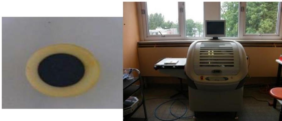
Figure 9. Sérigraphieuse DEK 248 à droite. Pastille de CGO avec un dépôt d'encre de BCO à gauche
