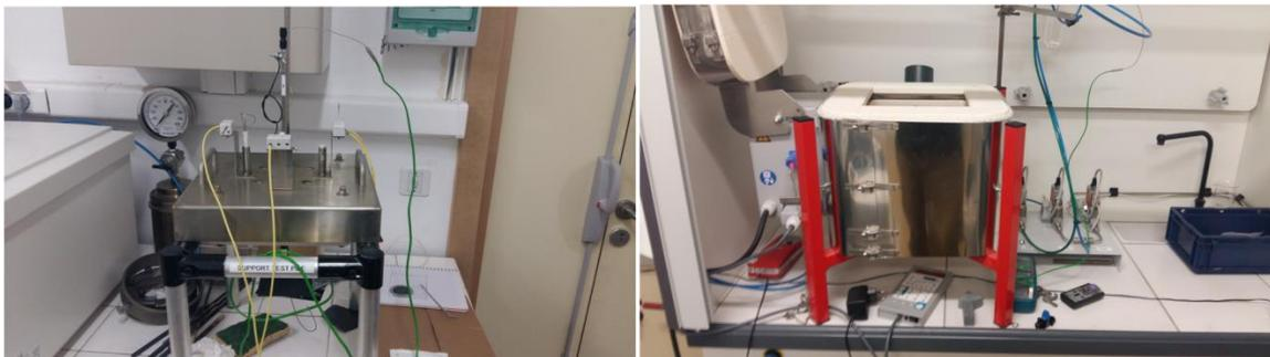
Figure 44. Photo du montage de test de performance de pile à combustible à oxyde solide
