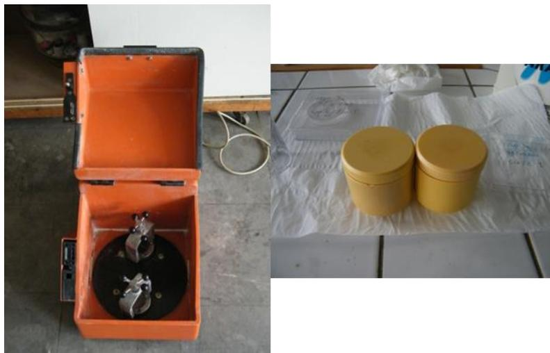
Figure 5. Broyeur planétaire et bols en zircone.
