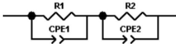
Figure 25. Circuit équivalent proposé pour la modélisation des diagrammes d'impédances des phases  $\text{La}_4\text{Ti}_2\text{O}_{10}$  et  $\text{La}_4\text{Ti}_{1,8}\text{V}_{0,2}\text{O}_{10\pm\delta}$
