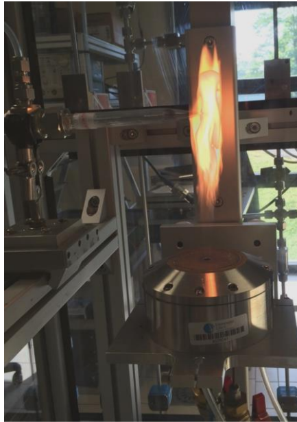
Figure III.11: Prélèvement des suies dans la flamme de laboratoire avec la microsonde.
