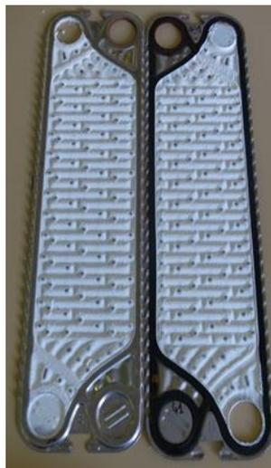
*Figure 4.10. Dépôt formé dans le 5<sup>ème</sup> canal de l'ECP pour le profil thermique # 1
