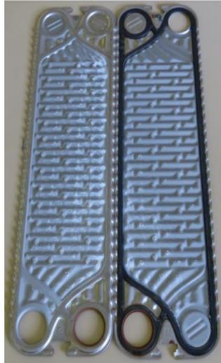
*Figure 4.9. Dépôt formé dans le 2<sup>ème</sup> canal de l'ECP pour le profil thermique # 1
