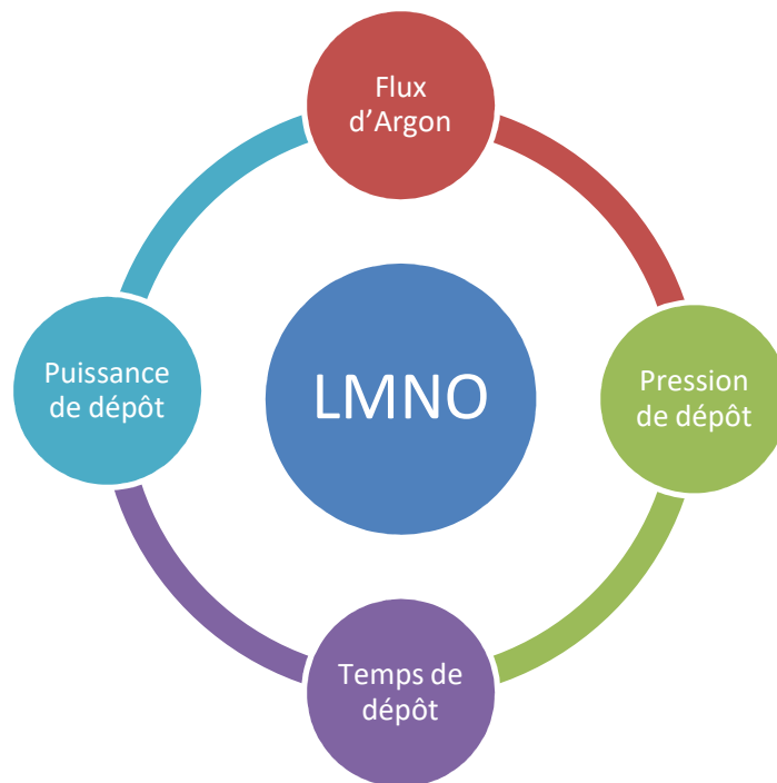
Figure 4.2: Les différents paramètres de dépôt en pulvérisation cathodique RF, que nous avons choisi de faire varier lors de cette étude.
