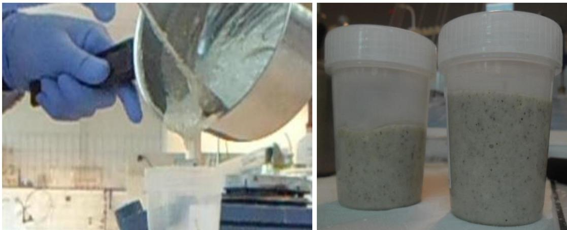
Figure n°49 : Transvasement et conditionnement de la bouillie optimisée
