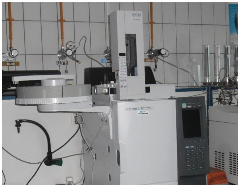
Figure n°35 : Photographie de l'équipement pour GC – MS
